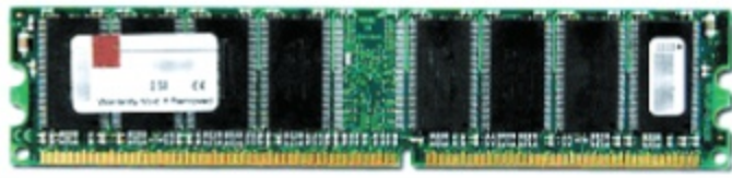
একটি র‍্যামের ছবি, এক পিগা র‍্যামে প্রায় দশ লক্ষ শব্দের সমান তথ্য রাখা যায়
