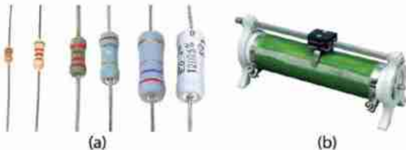
চিত্র 11.06: (a) স্থির এবং (b) পরিবর্তী রোধ
