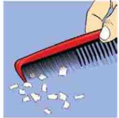
চিত্র 10.05: শীতকালে চিবুনি দিয়ে চুল আঁচড়ে ছোট কাগজের কাছে ধরলে সেগুলো আকর্ষণ অনুভব করে।
