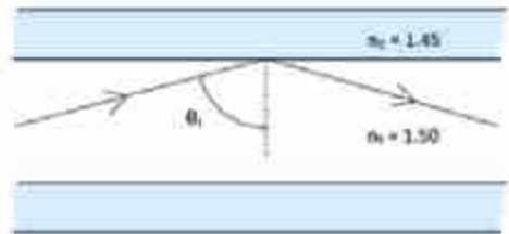
চিত্র 9.11: অপটিক্যাল ফাইবারের কোর থেকে ক্লাডে আলোর পূর্ণ অভ্যন্তরীণ প্রতিফলন হয়।
