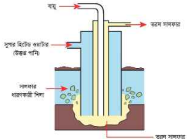
চিত্র: 10.12: ফ্রাশ পদ্ধতিতে সালফার উত্তোলন।
