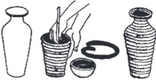
কয়েল লাগানোর পর পাত্রের ভেতর দিকের দাগ মিলিয়ে সমান করে দিতে হয়
