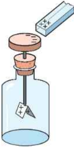
চিত্র 10.08: ইলেকট্রোস্কোপে চার্জের উপস্থিতির কারণে সূক্ষ্ম ধাতব পাত পরস্পর থেকে সরে যায়।
