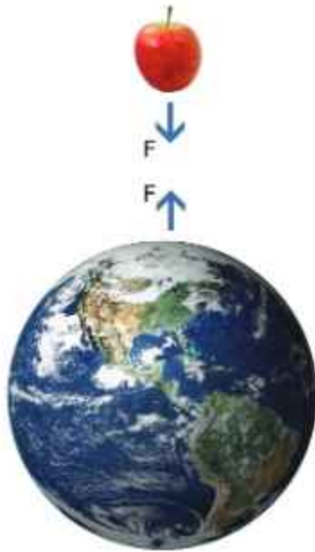
চিত্র 3.12: একটি ভরকে পৃথিবী যেমন আকর্ষণ করে, ভরটি পৃথিবীকেও সেভাবে আকর্ষণ করে।
