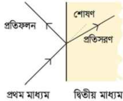
চিত্র 8.02: এক মাধ্যম থেকে অন্য মাধ্যমে আলোর প্রতিফলন, প্রতিসরণ ও শোষণ।
