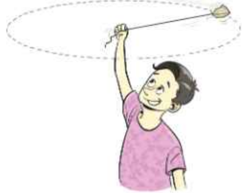
চিত্র 2.05: সূতায় বেঁধে একটি পাথর ঘোরানো হলে দ্রুতি এক থাকলেও বেগের পরিবর্তন হয়।
